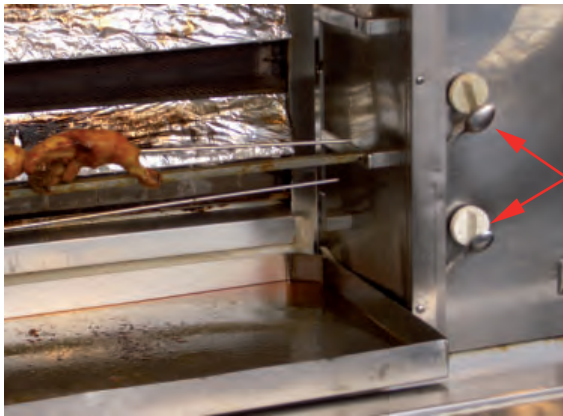
Abb. 32: Grillgerät eines Hähnchengrillwagens mit manipulierten Ventilen
