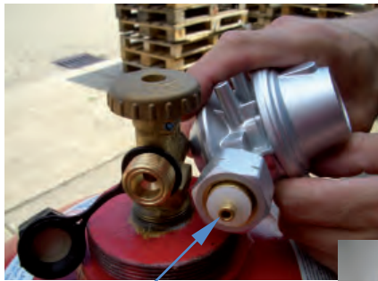
Abb. 16: Beispielhaftes Druckregelgerät (mit integrierter Überdrucksicherheitseinrichtung) mit Kombinationsanschluss sowie Dichtring - Einsatz nur mit Dichtring, unabhängig vom Dichtsystem der Flasche (z.B. 5-kg-, 11-kg-, 33-kg-Flasche)
