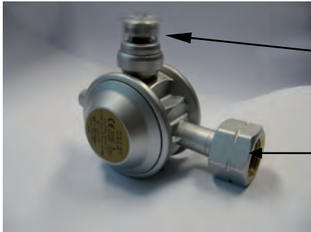
Abb. 10: Beispielhaftes Niederdruckregelgerät mit Kombinationsanschluss für 5-kg-, 11-kg-, 33-kg-Flaschen bis zu einer maximalen Entnahmemenge von 1,5 kg/h mit integrierter Überdrucksicherheits-einrichtung sowie Sichtanzeige
