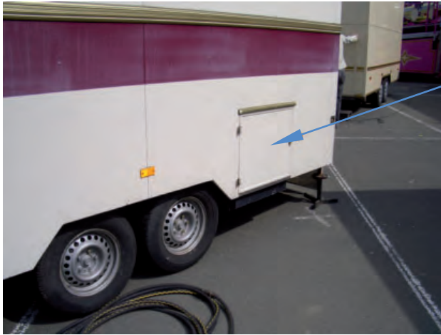
Abb. 37: Von außen zugänglicher Kasten (Schrank) für Flüssiggasflaschen
