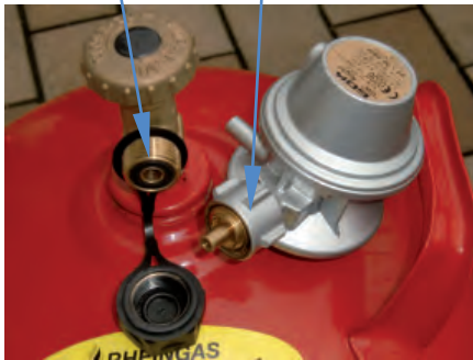
Abb. 14: Absperrventil 11-kg-Flasche mit Gummidichtring im Entnahmestutzen und Druckregelgerät
