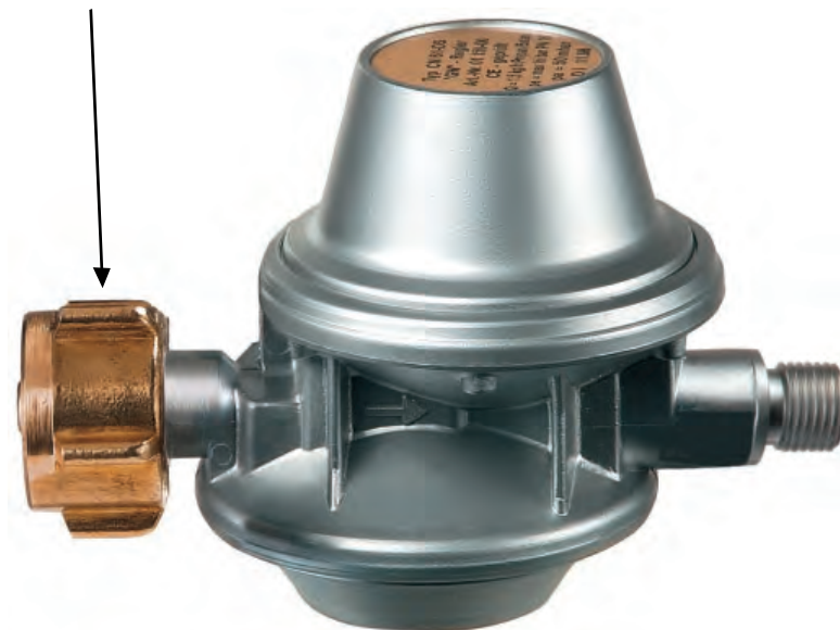
Abb. 9: Beispielhaftes Niederdruckregelgerät für Kleinflaschenanlagen bis 14 kg Füllgewicht mit integrierter Überdrucksicherheitsvorrichtung
