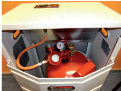
Abb. 33: Katalytöfen mit Druckregelgerät mit integrierter Überdrucksicherheitseinrichtung und thermischer Absperrereinrichtung
