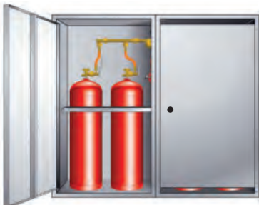
Abb. 5: Verschließbarer Flaschenschrank mit Lüftungsöffnung
