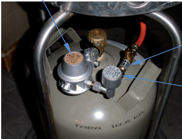
Abb. 36: Sicherheitseinrichtungen (Druckregelgerät mit integrierter Überdrucksicherheitseinrichtung, Gas-Kippschutzventil, Schlauchbruchsicherung) an Terrassenheizstrahlern und Gasfackeln
