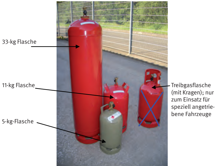
Abb. 2: Flüssiggasflaschen (Brenngasflaschen) ohne Ventilschutzkappe
