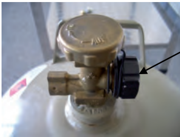
Abb. 41: Flüssiggasflaschen-Absperrventil mit aufgeschraubter Ventilverschlussmutter
