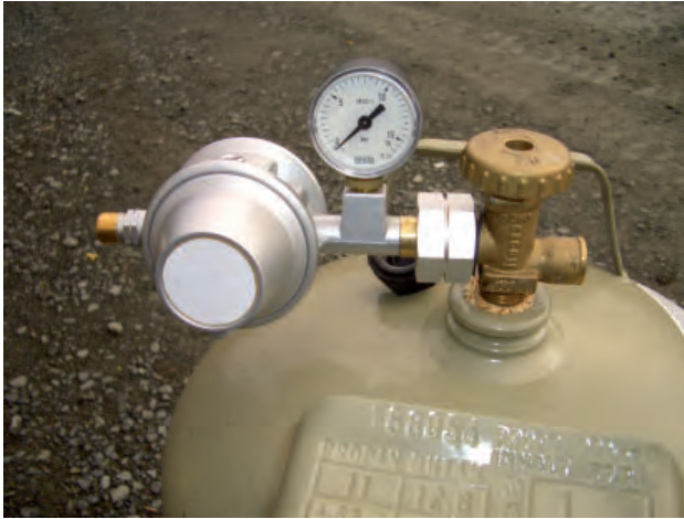
Abb. 31: Beispielhaftes Druckregelgerät mit integrierter Überdrucksicherheits-einrichtung und Manometer zur Dichtheitskontrolle
