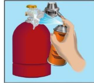
Bild 5 Dichtheitsprüfung der Anschlussverbindung
